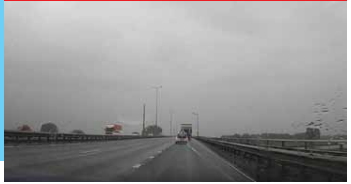
Foto boven: Het voertuig reageerde op de oude, half versleten markering over de opengestelde spitsstrook. Een ingreep van de bestuurder was noodzakelijk om niet op de naastgelegen rijstrook te belanden.
