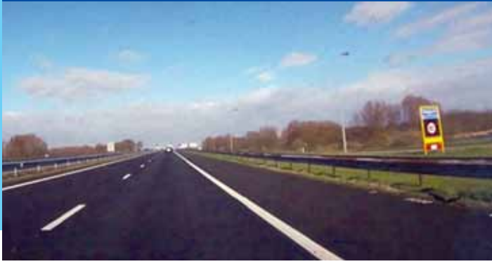
Foto boven: De RSA herkende onbedoeld het snelheidsbord op de parallelweg rechts (!). Links: Vochtig wegdek, zonlicht en vage markering: het LKAS ziet de lijn niet waardoor het voertuig midden op de weg rijdt.
